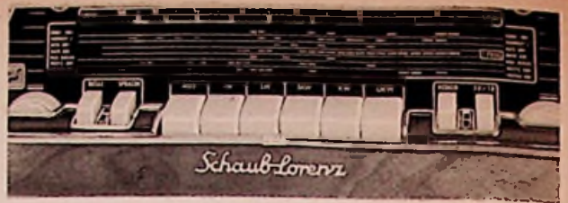
Bild 2. Skalenausschnitt, Tastenreihen und Tonregler des Schaub-Lorenz W 52
